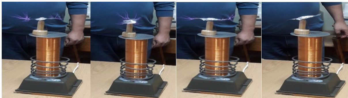
Рис. 8 «Спрінклер Фейнмана» (іонний вітер)
