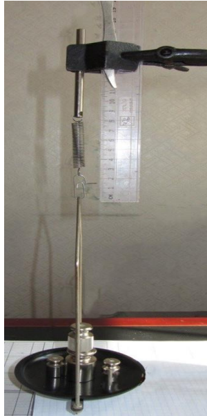
Рис. 2. Тарування пружини динамометра приладу Ф24-1
